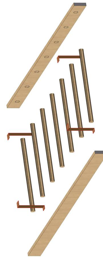
Leg alle Elemente auf einen Teppich oder Unterlage und positioniere die Sprossen zwischen den Seitenwangen.
