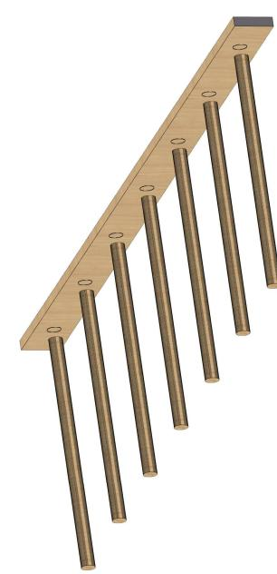
Stecke die Sprossen in die Fräslungen der Seitenwange und verschraube diese an den vorgebohrten Positionen.
