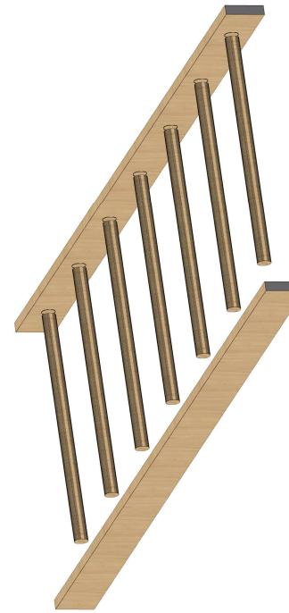
Stecke nun das verschraubte Element in die linke Seitenwange und verschraube die Sprossen mit der Seitenwange an den vorgebohrten Positionen.
