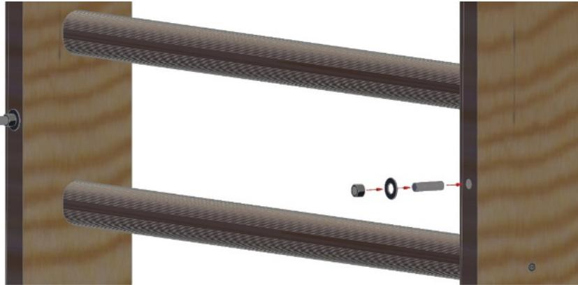
Die Montageplatte wird nun mit dem Gewindebinder auf die gerade installierte Gewindestange geschraubt.
