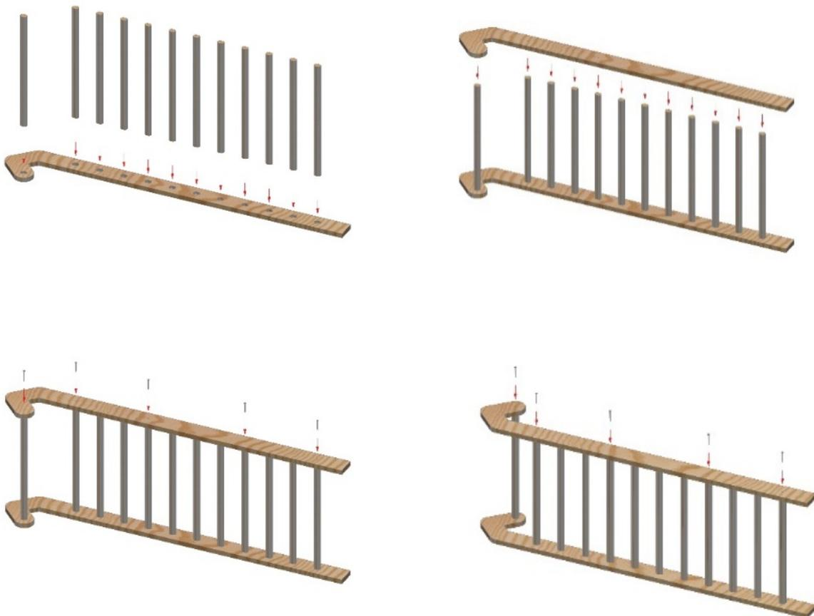
Nimm je eine Gewindestange und schraube Sie in die Rückseite deiner MURUM Sprossenwand in die dafür bereits vorinstallierten Gewinde.
